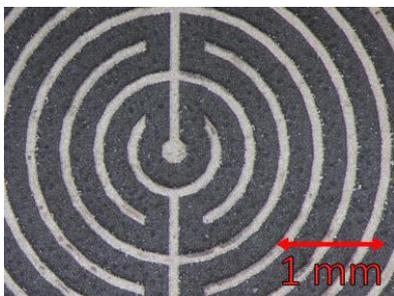
Oben: Elektrodenstruktur auf einem Piezomaterial
